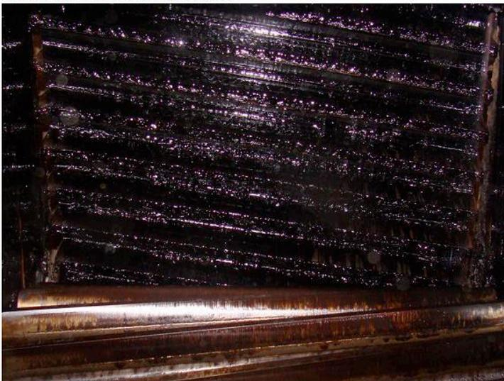
TRANSMISIÓN LUBRICADA CON GEAR FLUID 550, SE OBSERVA UNA LUBRICACIÓN LIMPIA Y SIN DAÑOS EN LA CORONA
